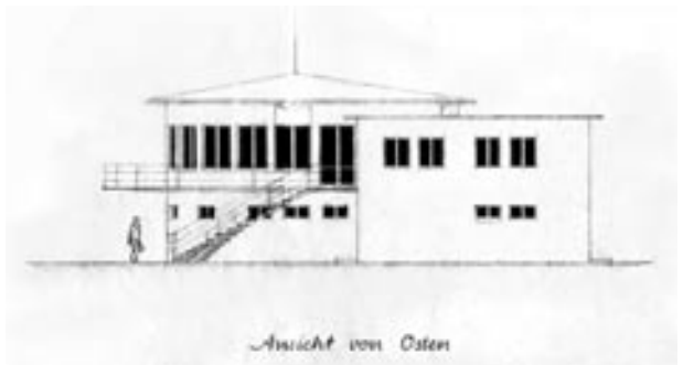
Ansicht von Osten, Bauantrag vom 13. Januar 1954. Tatsächlich ausgeführt wurden deutlich größere Fenster im Rundbau, die einen noch offeneren Kontakt zum Außenraum ermöglichen.
